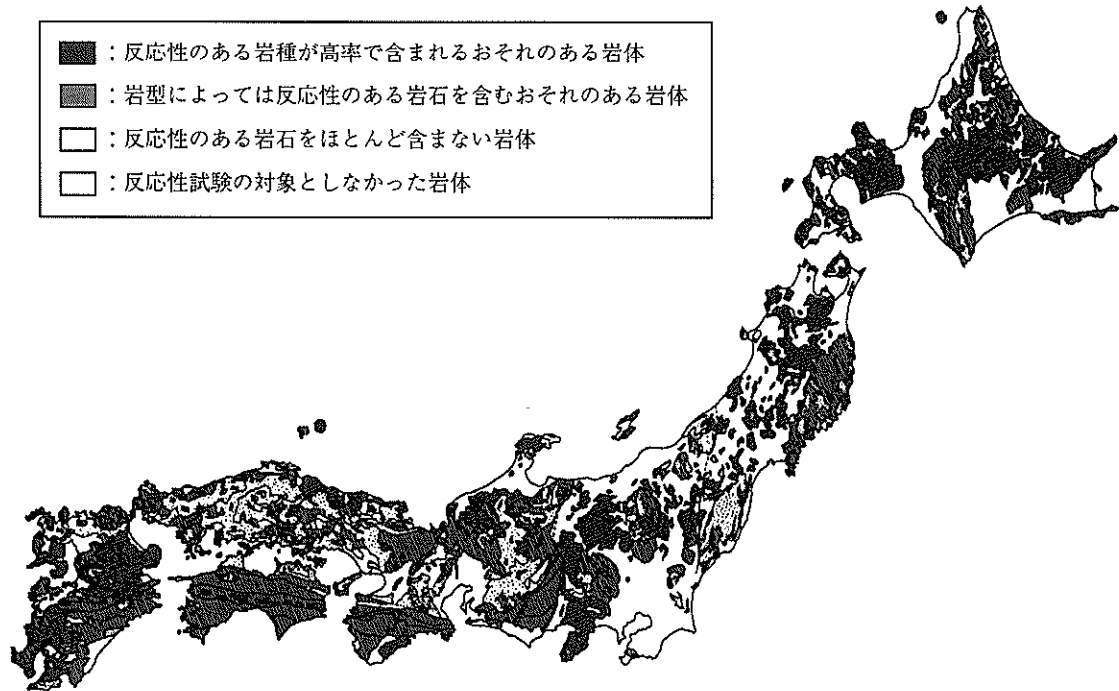
付図-B.1 日本国内における ASR 反応性骨材分布図 10)
