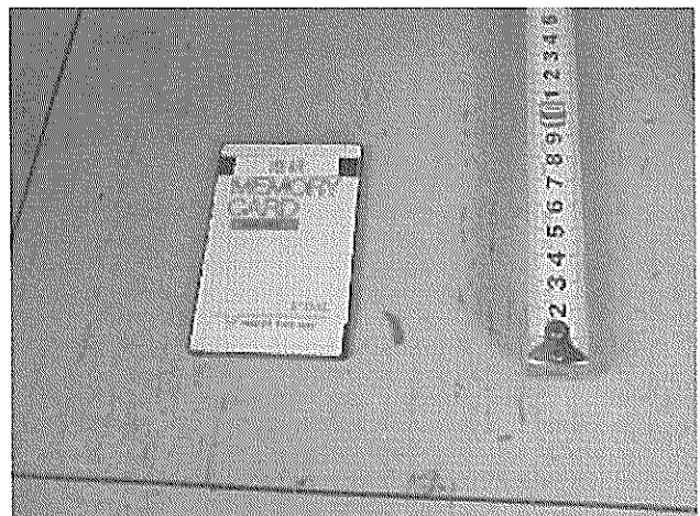
図-16 ERS-G/GV 型強震計の IC カードメモリ
