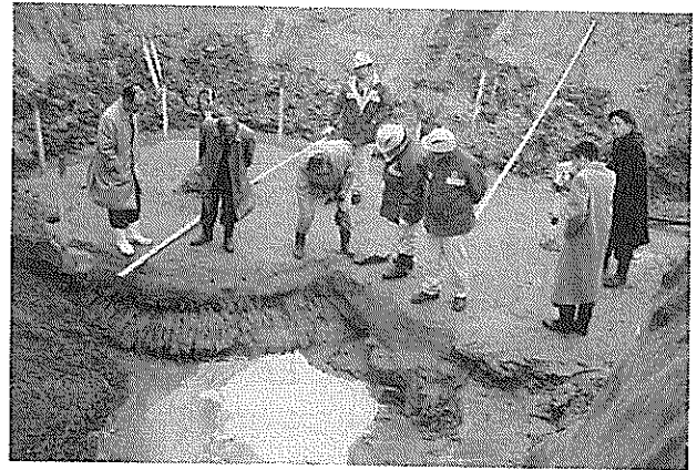
写真-2 掘起こし調査による改良体の確認状況
