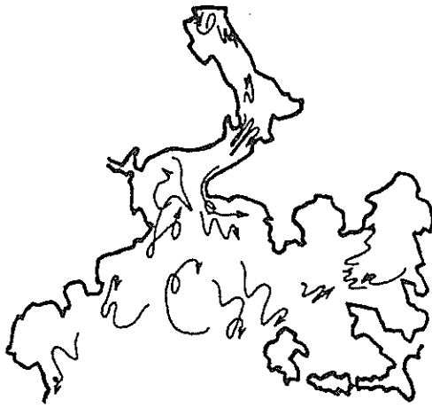
図-3.47 須崎港の水理模型の流況図 (密度流無し, 防波堤無し)
