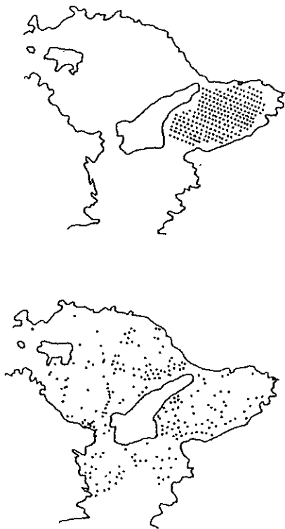
図-3.10 浮子追跡による海水交換の考え方
