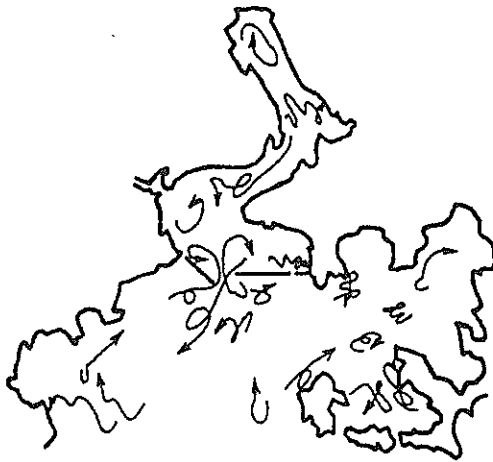
図-3.48 須崎港の水理模型の流況図 (密度流無し, 防波堤有り)
