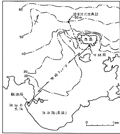
図-5.17(a) 浜田港・観測施設の配置 測定点～観測局 (第三港湾建設局)
