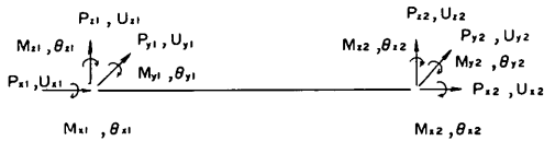
図 A. 5 部材の材端力と変位
