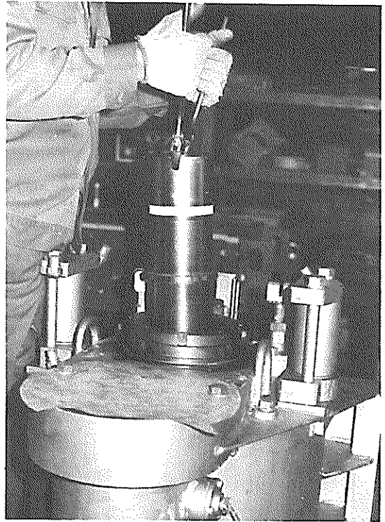
写-3.7.2 (b)ドリルヘッドに新しく内蔵されたスライド部の組立作業
