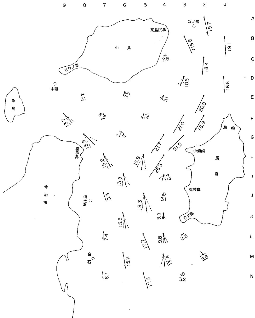
図-13-1 流速・流向ベクトル表示図 (case 2)
