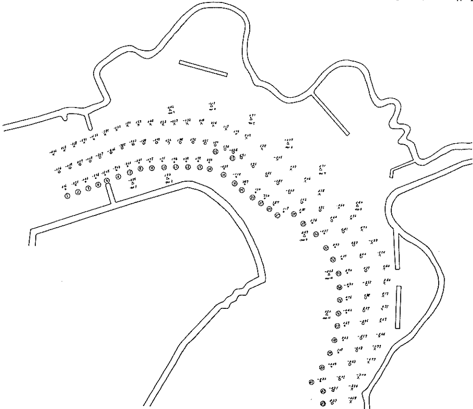
図-5 移動床実験 S40.2.1 case 10分 Q 55ℓ/sec W.T 9.20
