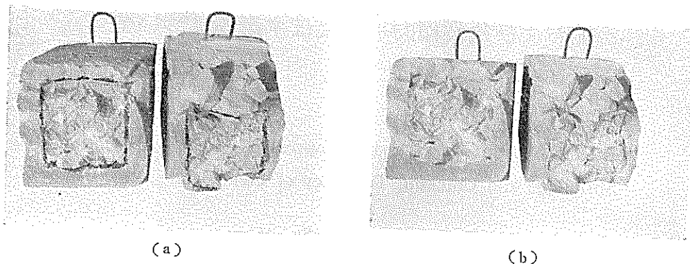
図—5・6 鉄筋ガラス・コンクリート供試体の切断面
