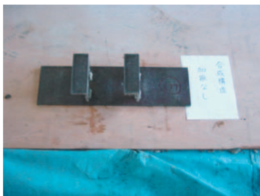
付写真-6.7 供試体からはつり出した鋼材①
