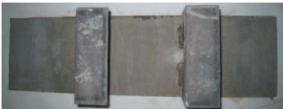
RC供試体の丸鋼(かぶり3cm)
