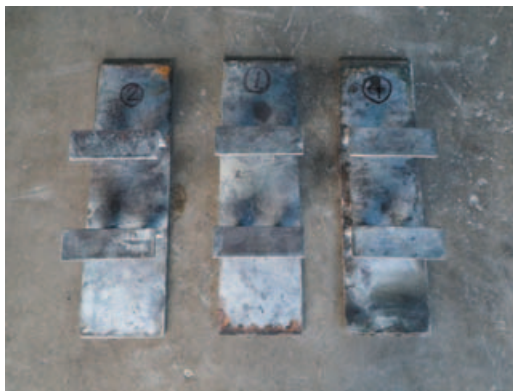
付写真-6.13 鋼材腐食状況
