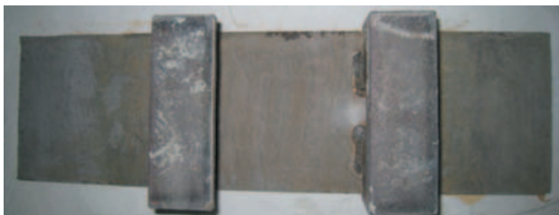
RC供試体の丸鋼(かぶり3cm)
