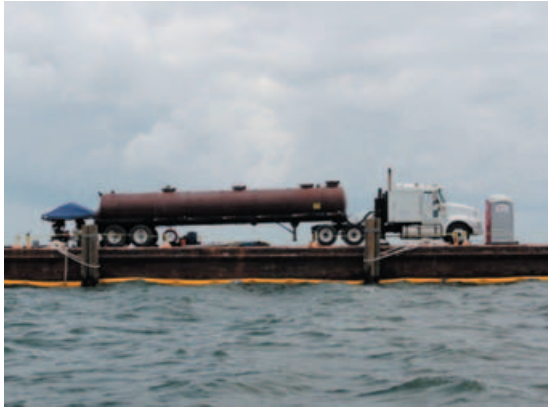
写真-5 ポンツーン上のタンクローリー
