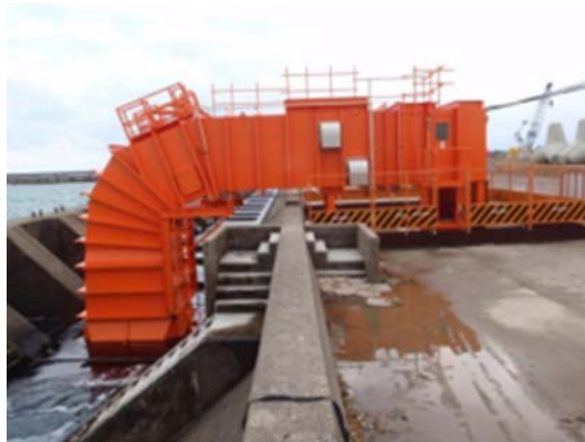
図-1.1.1.22 酒田港における多重共振型波力発電システムの実証実験
