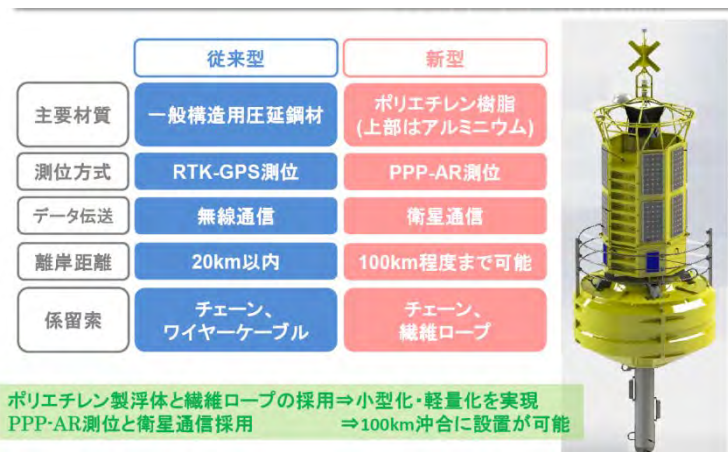
図-1.1.1.4 新型 GPS 海洋ブイの実験機的主要特徴
