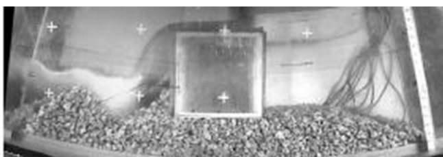
写真-1.1.1.6 遠心場における津波越流実験（マウンドが洗掘される）
