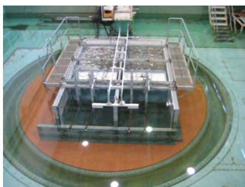
図-1.1.2.3 水中振動台模型振動実験と、実験および数値解析結果の比較
