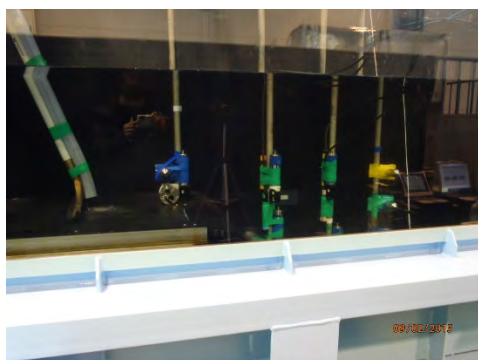
写真-1.1.2.1 河口部での濁水挙動の把握を目的とした水槽実験
