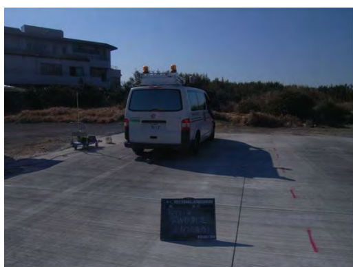
写真-1.1.1.7 空洞を有するエプロン 舗装の健全性評価実験写真
