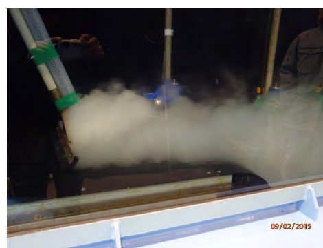
写真-1.1.2.1 河口部での濁水挙動の把握を目的とした水槽実験
