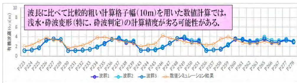
図-1.1.1.15 孤立リーフ周辺の波浪変形に関する実験結果と再現計算結果の比較
