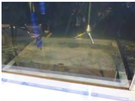
図-1.1.1.17 現地底泥を用いた巻き上げ試験の様子（左）と底質条件（含泥率）の違いによる巻き上げ濃度の変化に関する測定結果（右）
