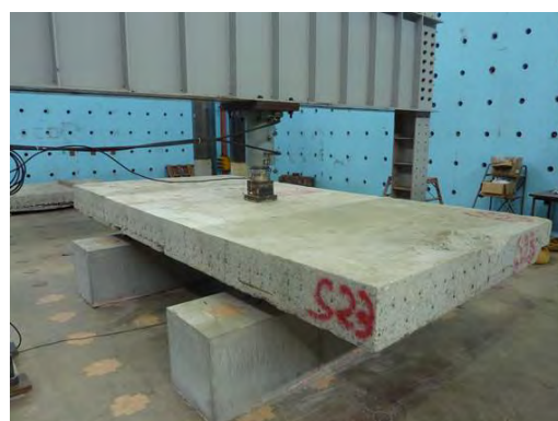
写真-1.1.1.8 鉄筋コンクリート部材の 構造安全性評価実験
