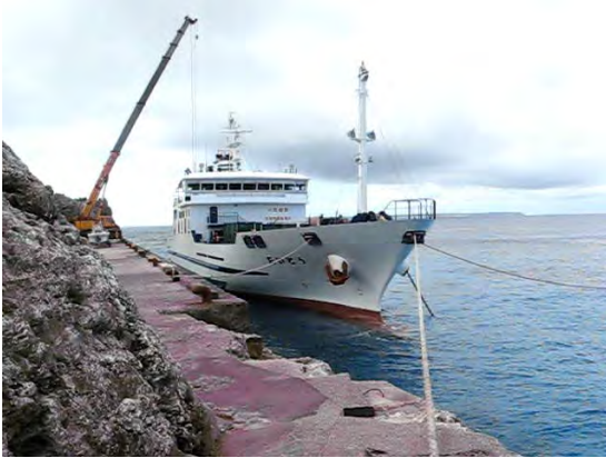
写真-1.1.1.9 北大東島西地区における荷役状況（沖の係留ブイからも係留索をとる）
