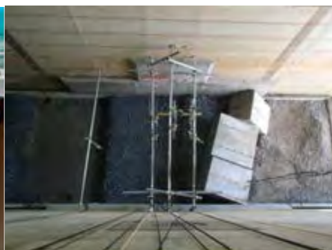
写真-1.2.1.1 越流と地震の複合により滑動した模型
