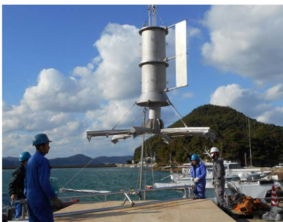
写真-1.1.1.2 海底ゴミ回収装置 (実海域試験装置)
