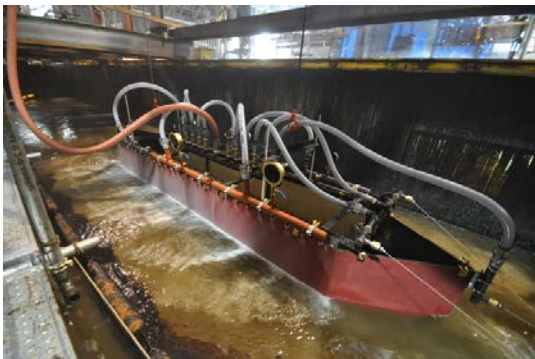
写真-1.1.1.1 油回収船模型の防汚総合試験
