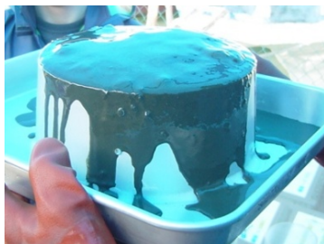
写真-2.3.1 東京湾の海底泥 (コアサンプルを押し出した様子)
