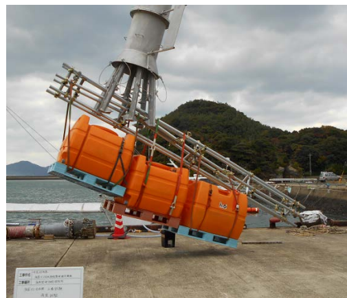
写真-1.1.1.3 陸上実験 (1ton荷重試験)
