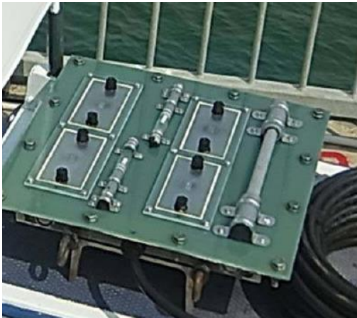
図-2.3.1.3 鋼材試験片（設置前）
