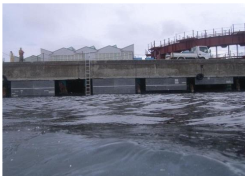
写真-1.1.2.1 前垂れによる波浪抑制効果の確認実験
