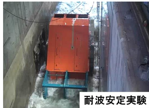
図-1.1.1.9 既設防波堤を利用した波力発電システム
