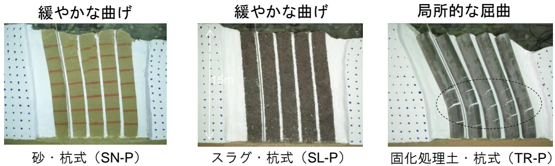
図-1.1.1.7 杭式改良地盤の変形・破壊挙動に関する遠心模型実験
