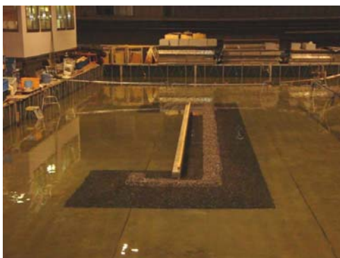
写真-2.1.4.7 長周期波対策消波工を対象とした斜め波の反射実験
