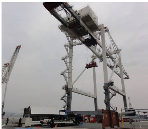
写真-1.2.1.5 実機コンテナクレーンの加振実験（平成 23 年 2 月 博多港）
