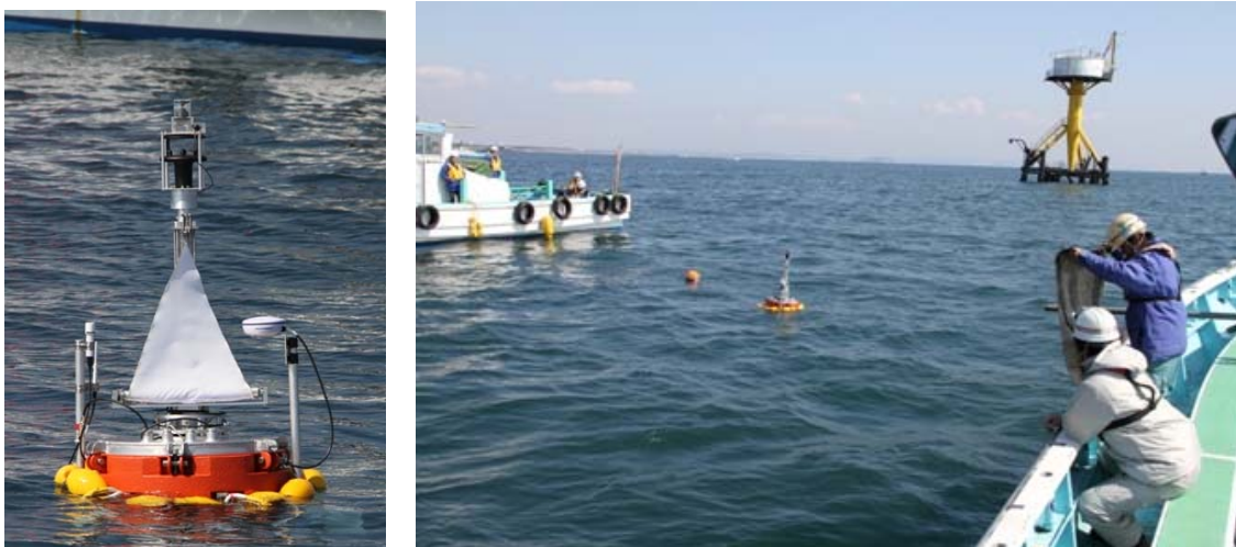
写真-2.1.1.10 自動追跡ブイの実海域実験（平塚沖）（平成 23 年 3 月）
