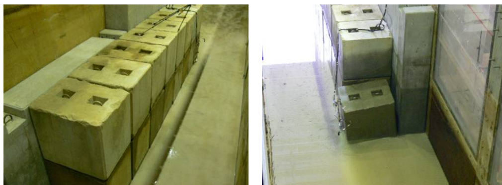
写真-2.1.4.5 防波堤下部の洗掘実験において傾斜したケーソン模型（左は実験前）
