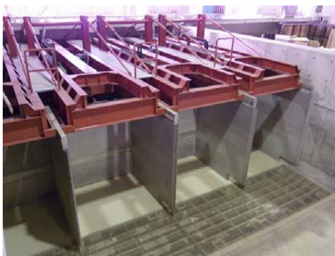
写真-4.1.1.3 水理模型実験水槽の造波装置と潮流吐出口(床面部)
