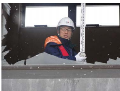
写真-2.2.8.1 仙台塩釜港における津波痕跡高の計測（平成 23 年 3 月 17 日）
