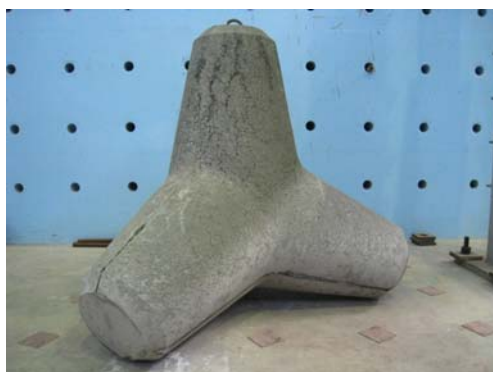
写真-2.1.4.4 スラグ細骨材を全量混合したコンクリートで作製した消波ブロック
