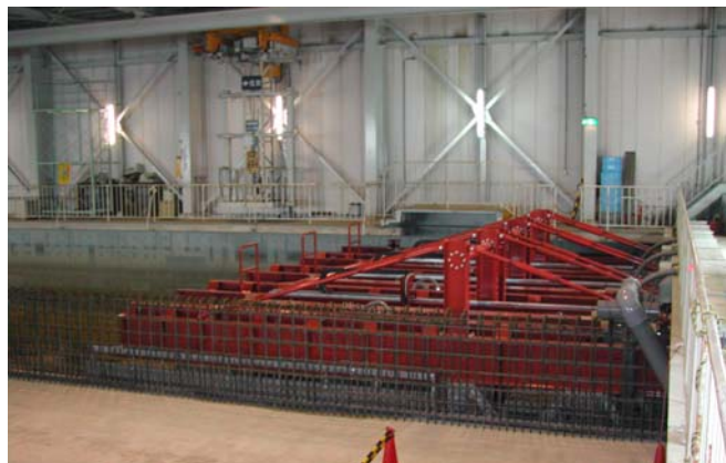
写真－4.1.1.2 水理模型実験 水槽の造波装置
