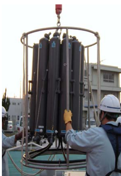
写真-2.1.3.4 多項目水質計付ロゼット採水器による伊勢湾海水の採水風景
