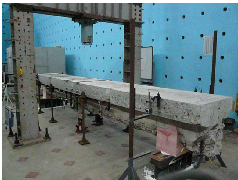
写真-2.1.1.7 劣化した港湾構造物から切り出した部材の載荷実験 (供用後 40 年を経た栈橋上部工部材)
