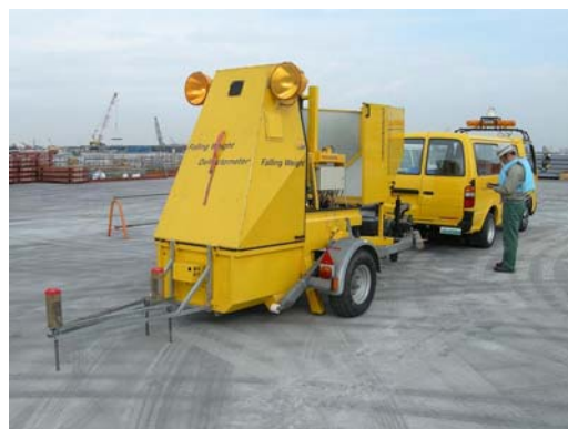
写真-1.2.1.9 東京国際空港（羽田空港）D 滑走路 工事区域における滑走路健全性診断 手法開発に関する実験
