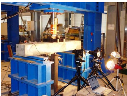
写真-2.1.3.1 鉄筋コンクリートの変形挙動の撮影状況
