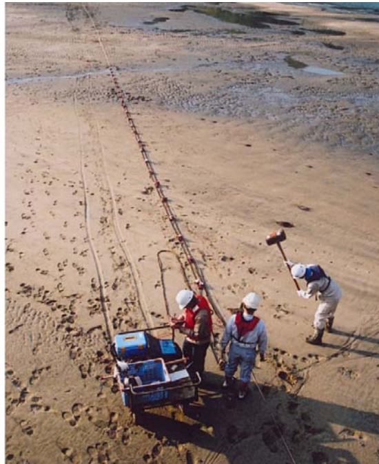
写真-1.2.1.5 表面波探査による干潟のせん断波速度構造調査 (平成 21 年 4 月 徳山下松港人工干潟)
