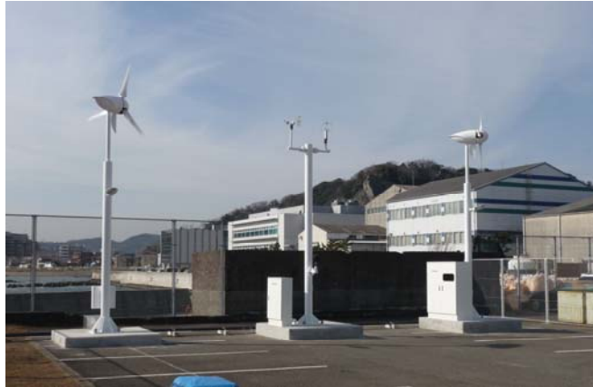
写真-4.1.1.5 研究所構内に新設された2基の小型風車（両側）と風向風速計（中央）
