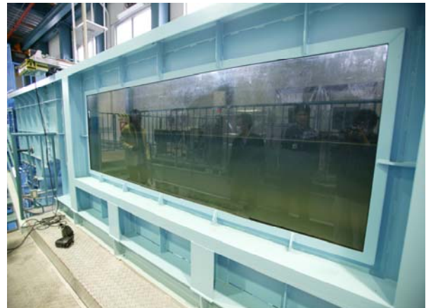
写真-2.1.1.16 海底流動実験水槽
