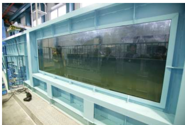
写真-2.1.10 海底流動実験水槽
