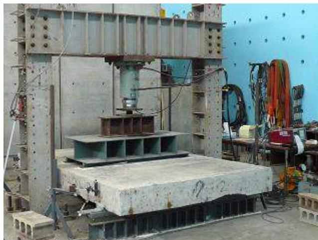
写真－2. 1. 17 塩害を受けて劣化した栈橋上部工から切り出した コンクリート部材の載荷実験
