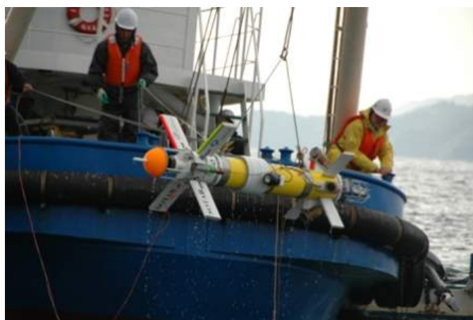
写真-2. 1. 11 自動追跡ブイの実海域実験（舞鶴港沖）
