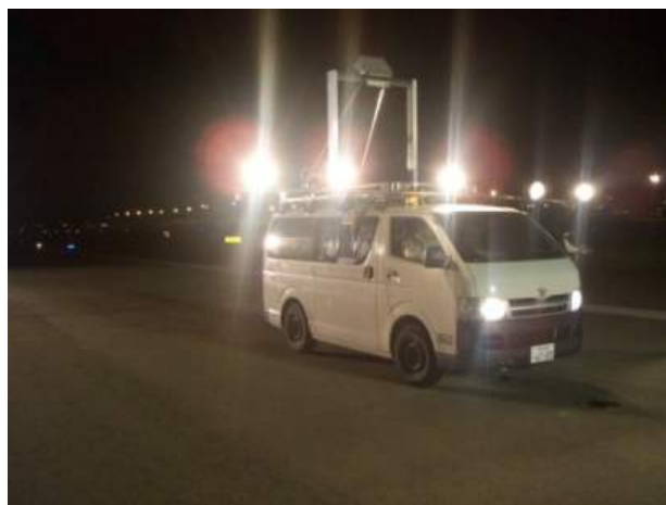
写真－2. 1. 4 赤外線を用いた舗装損傷部の検出実験（福岡空港）
