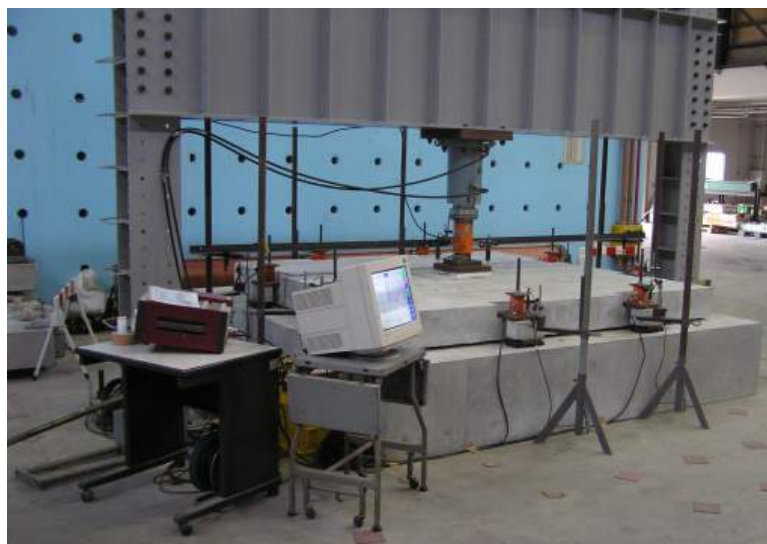
写真-1.2.5 棧橋の新構造形式（リプレイサブル床版）の実験
