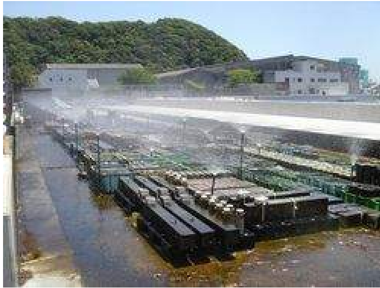
写真-2. 1. 12 海水循環水槽での暴露実験の状況
