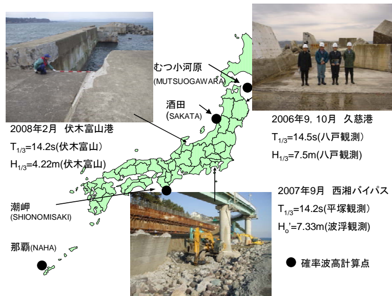
図-2. 2. 13 うねり性波浪による被災例と観測値の整理
