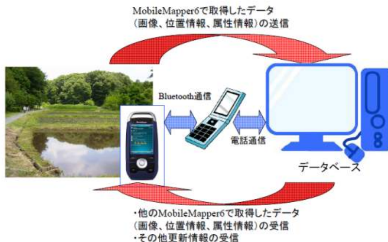
図-2.2.14 GPS 受信機による施設変状把握ツール
