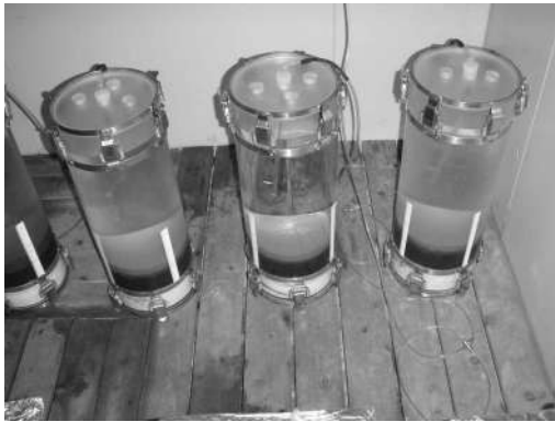
覆砂実験の状況
