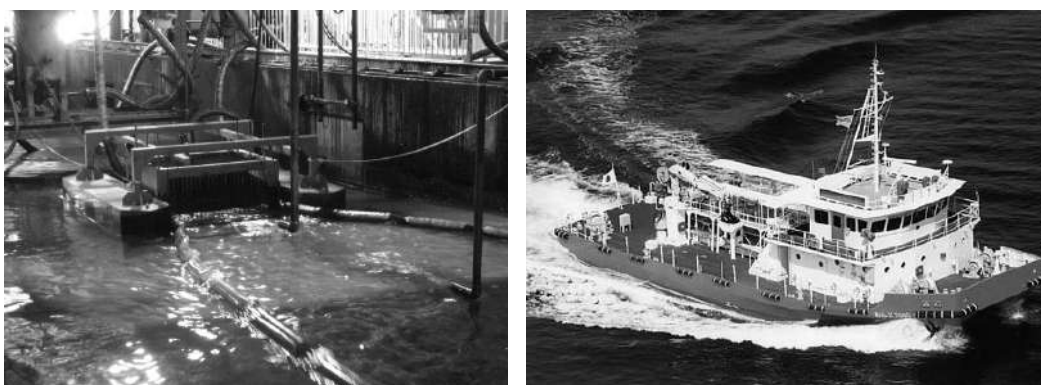
写真-2.1.20 簡易型油回収装置の性能試験（左）と 国土交通省中国地方整備局の海面清掃船「おんど 2000」（右）
