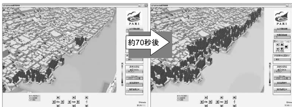
図-2.1.1 高潮津波シミュレータ（STOC）による解析例 （赤印は木造家屋半壊指数の浸水1m被害の例を示す）
