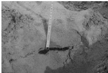
砂浜の油汚染—表層の油は概ね除去されたが、掘り返すと内部に写真の様な油層が見られる。間隙水にも油分が観察され、内部汚染の除去が今後の課題になると思われる。
