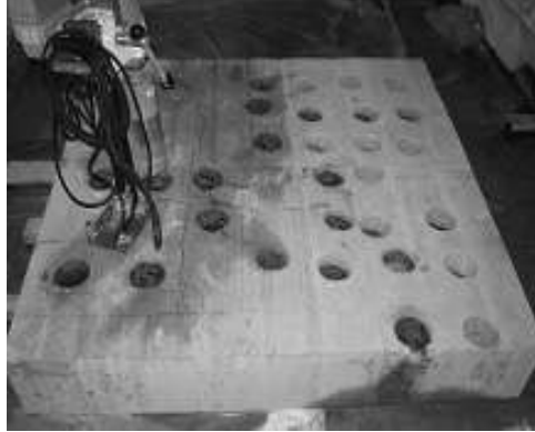
写真-2. 1. 8 海域施設の劣化状況のばらつきを測定する実験
