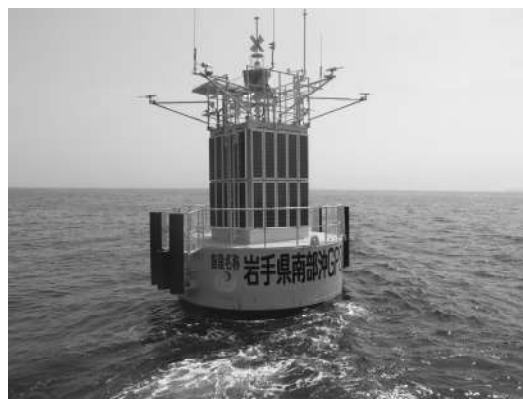
写真-2.1.12 GPS 波浪計（岩手県南部沖）
