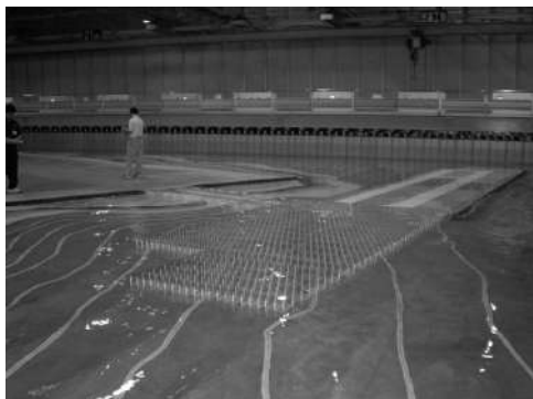
D 滑走路模型(中央右上から左下斜め部分の模型)における波と流れの状況を調べる実験
