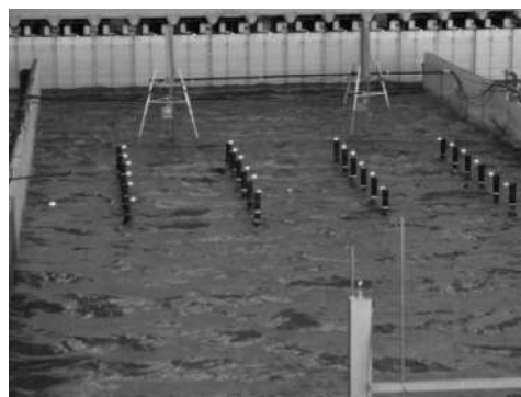
棧橋部の大縮尺による実験
