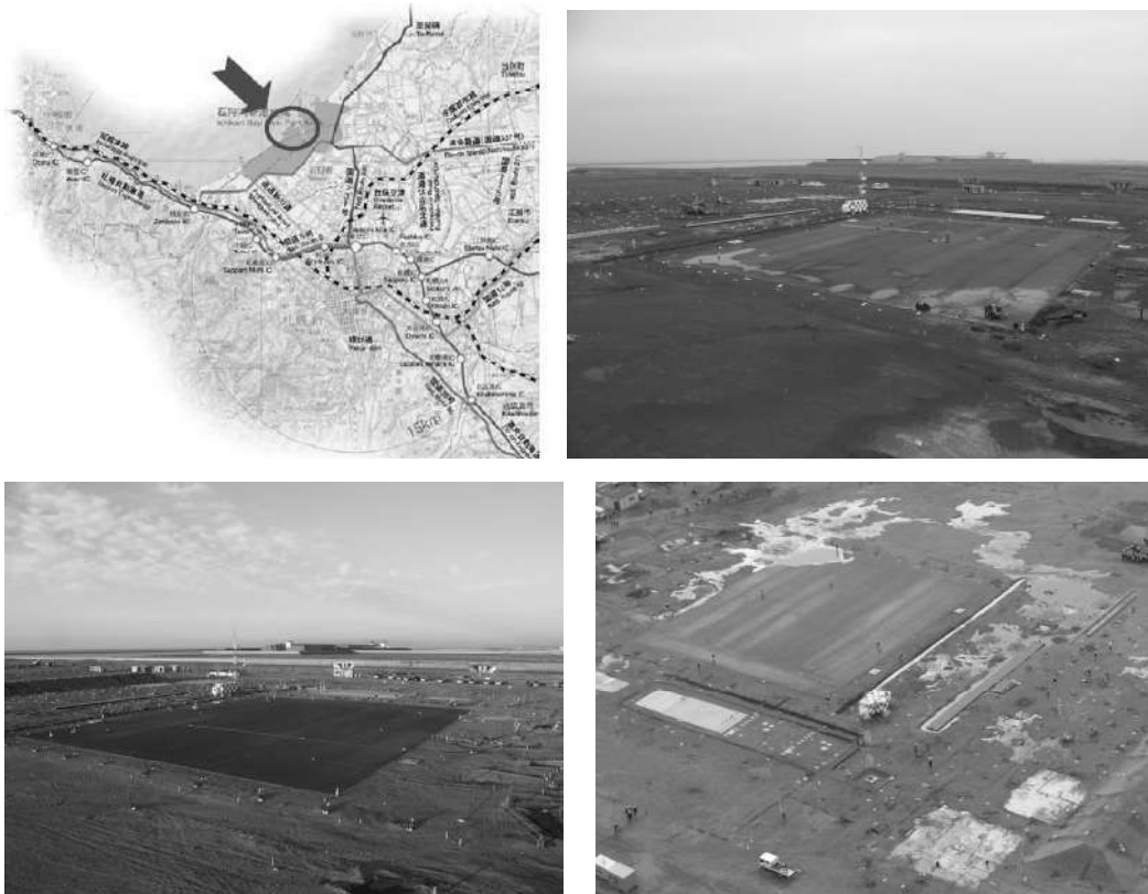
写真－2. 1. 27 石狩湾新港における実物大空港施設の液状化実験の状況
