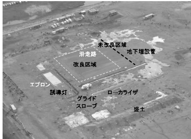
写真-2.1.1 石狩湾新港における実物大空港施設の液状化実験の状況（北海道開発局撮影）
