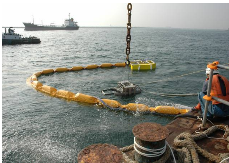
写真-2.1.7 浮遊重質油回収システムの運用試験（境港）
