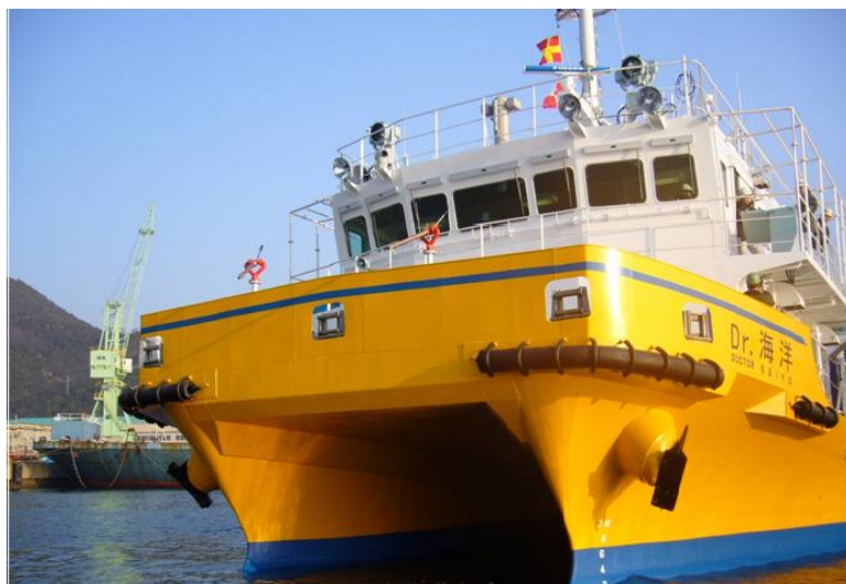
写真－2. 1.10 新型油回収装置を搭載した国土交通省近畿地方整備局の海面清掃船「Dr.海洋」
