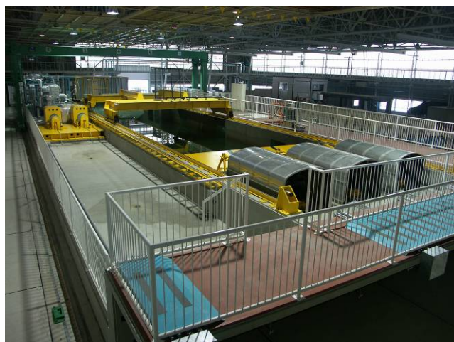
写真－7. 1. 5 海上漂流油回収環境再現水槽
