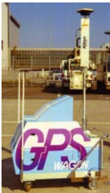
写真 - 2.3.9 羽田空港で活用される GPS 利用の高さ計測装置 （特許第 3193949 号）
