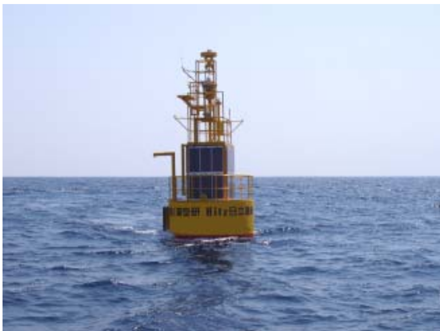
写真 - 2. 1. 3 室戸沖に設置された GPS 津波計
