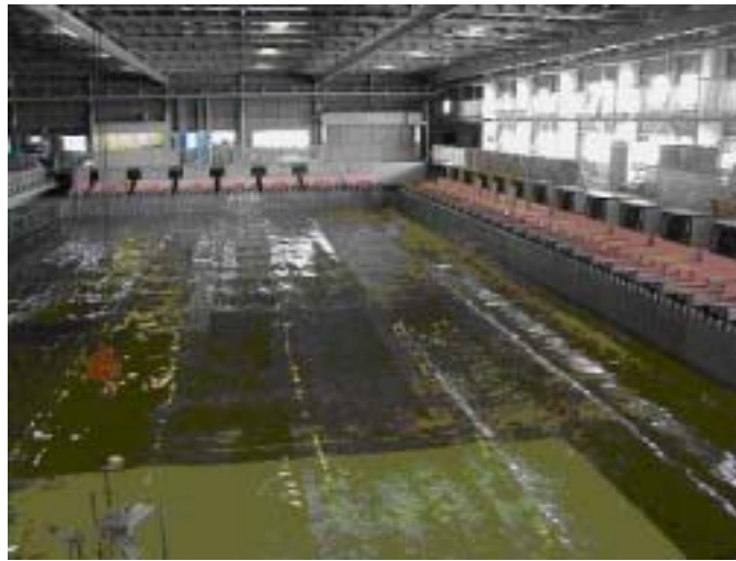
写真 - 7. 1. 1 デュアルフェイスサーペント型造波装置及び周辺機器
