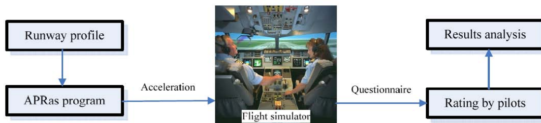
図-7.13 パイロットの主観に基づく縦断プロファイル評価についての研究手法
