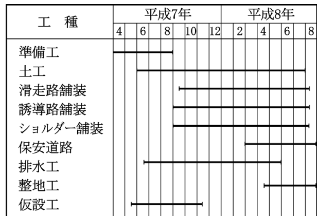
図-6.26 新C滑走路舗装の建設工程
