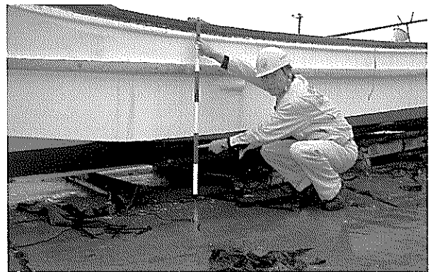
写真-32 浸水高さと上架船舶の関係（千代ノ浦漁港）
