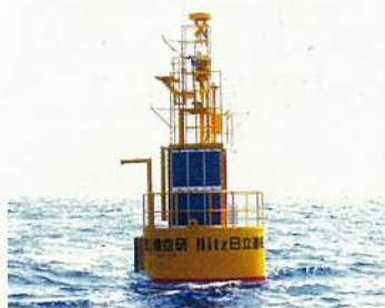
写真1: 室戸岬沖13km水深100m 地点に設置されたGPS津波計
