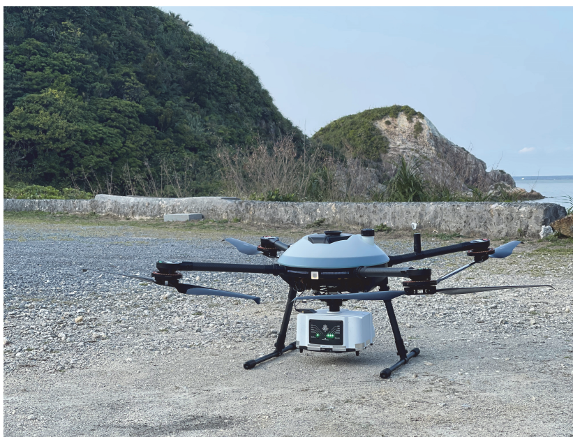
写真1 実証に用いたハイブリッドドローンとグリーンレーザースキャナ
