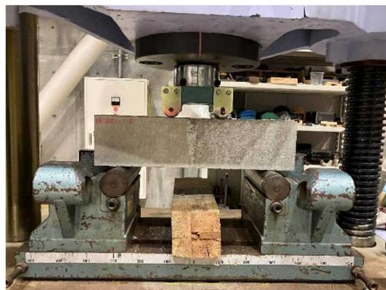
図-6 曲げ強度試験の実施状況
