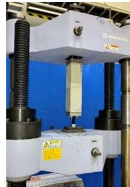
図-4 引張強度試験の実施状況
