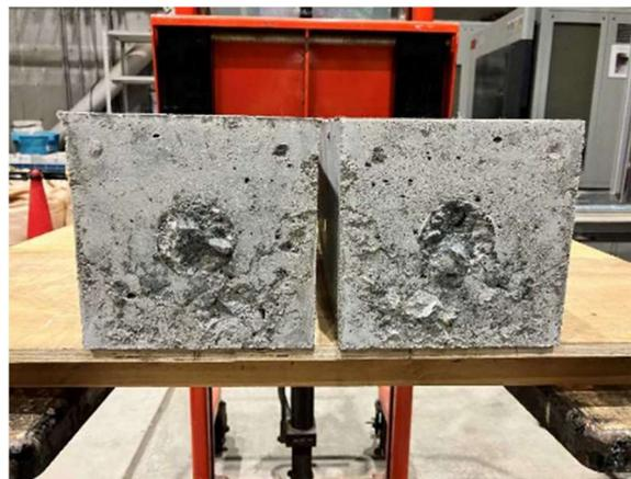
図-5 接合面の破壊状況の例 (BK150-1)
