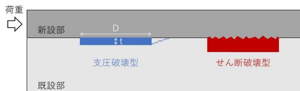
図-2 円柱状シアキーの破壊形態
