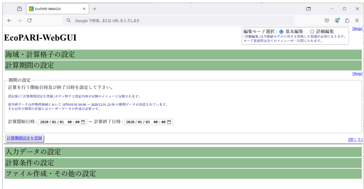
図 7 EcoPARI-Web GUI Pre での計算期間の設定画面. 境界条件ファイルとしてサーバー上にあらかじめ設定されているデータを使用する場合, ユーザーが選択できる期間が表示される. この図では, 「1970/01/01 00:00 ~ 2020/12/31 23:39」と表示されている.
