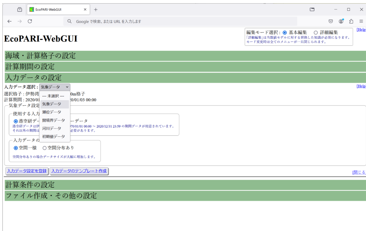
図 8 EcoPARI-Web GUI Pre での入力データ設定画面. ユーザーは、大気、開境界、開境界潮位、河川の各境界条件と、初期値データ（初期条件）を選択できる. ユーザーが自分で用意したデータを基に境界条件ファイルを作成したい場合、フォーマットに従い入力ファイルを作成するための CSV ファイルがダウンロードできる.
