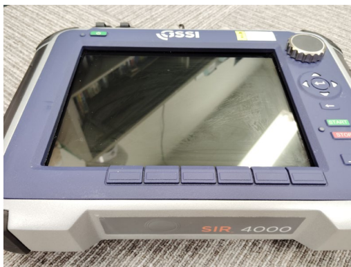
(b) SIR4000 地中レーダーデータ収録装置
