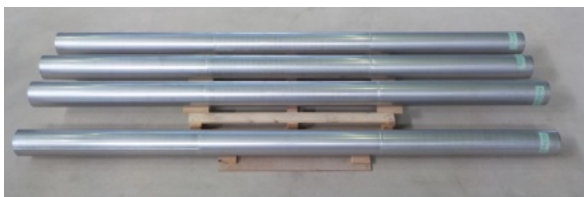
写真-1 模型杭 S (杭径小)
