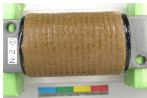
図-5 ペーストテープ+防食テープ試験体
