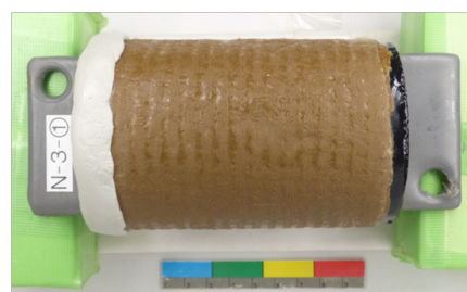
図-7 上端部シール試験体
