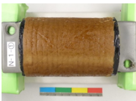
図-4 ペーストテープ試験体
