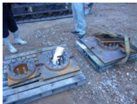
図-4.4 実験で使用した転圧板(左から450mm角, 600mm角, 900mm角)
