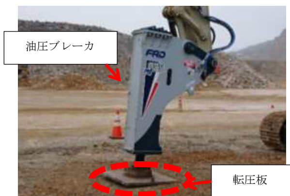
図-4.1 油圧ブレーカをベースとした均し試験装置
