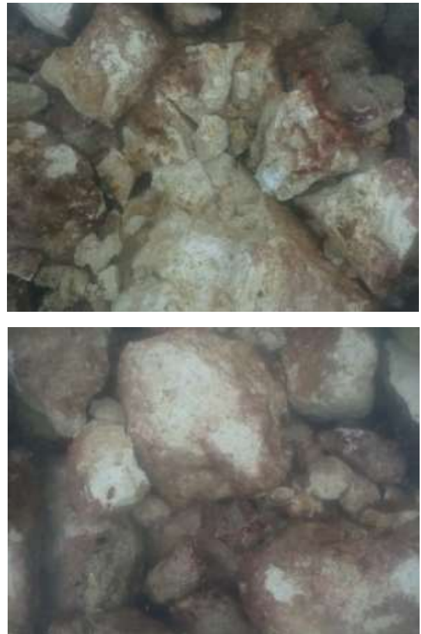
図-5.14 機構による打撃後の割石の破碎の様子
