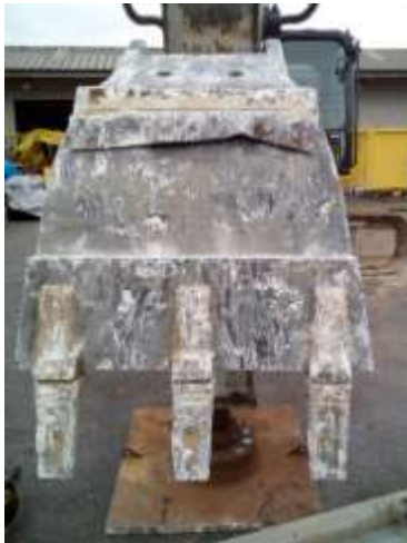
図-6.28 破損した背面の突起
