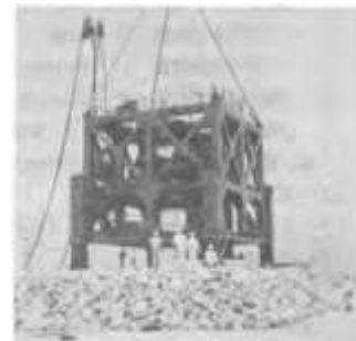
図-2.4 着座型タンパ式捨石均し機 (文献 4) より引用)
