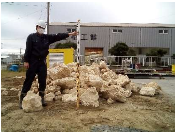
図-6.4 試験に使用した割石（上図：前面／下図：側面）
