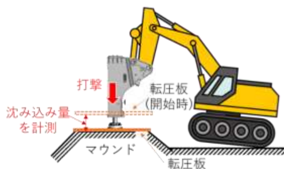
図-4.5 沈み込み量計測実験のイメージ図
