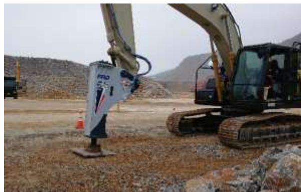
図-4.3 バックホウに取り付けた試験装置
