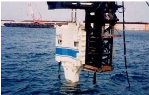
図-3.9 水中用パイプロハンマー (調和工業株式会社 HP より画像を引用) (引用元： http://www.chowa.co.jp/methods/ss60ws.html )
