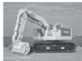
図-2.7 水中バックホウ「イエローマジック」 (文献 5) より画像を引用)
