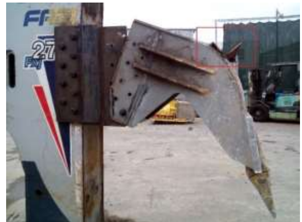
図-6.22 追加した突起（側方）
