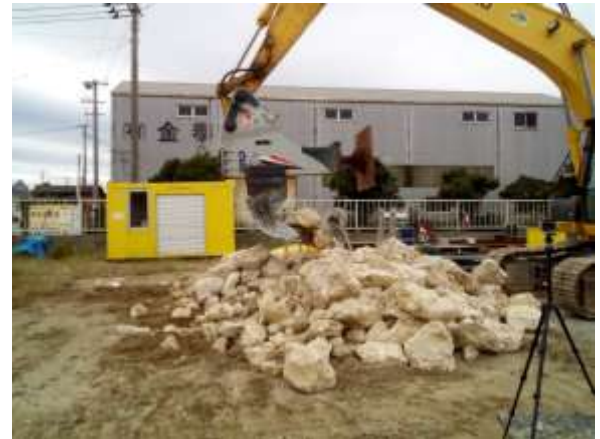
図-6.12 岩が落ち始める角度計測
