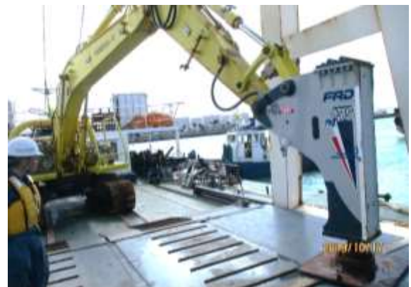
図-5.2 水中バックホウ TKM-200-9 に搭載された均しアタッチメント
