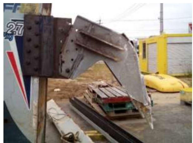
図-6.7 試験後のバケット写真（側面）
