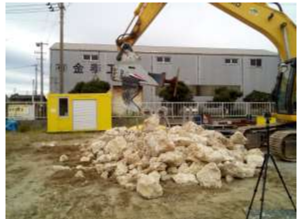
図-6.13 岩が落ち切った角度計測
