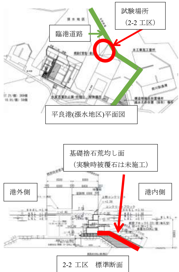
図-5.1 実験実施場所の平面図とその標準断面図
