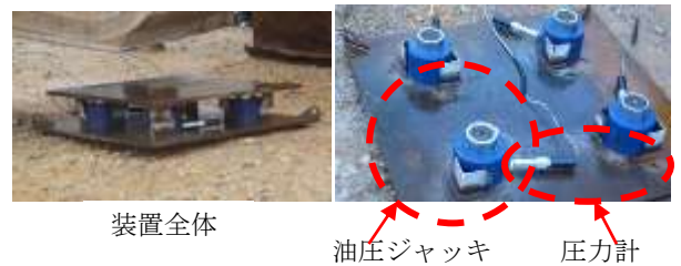
図-4.26 打撃力の計測装置の状況
