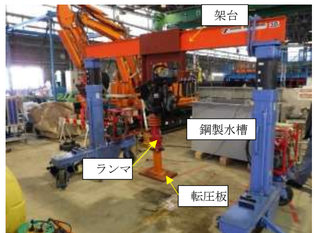
図-3.2 ランマの設置状況
