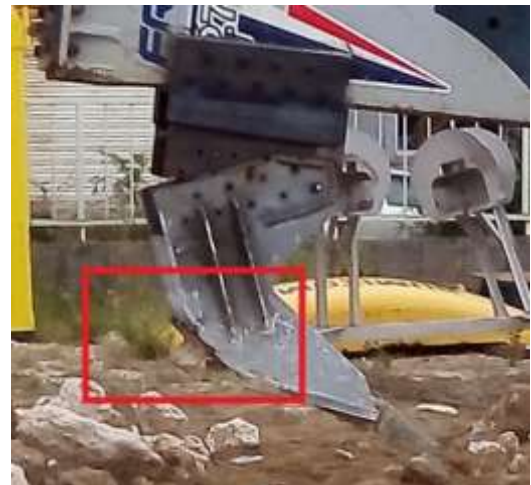
図-6.27 背面の突起が岩に引っかかる様子
