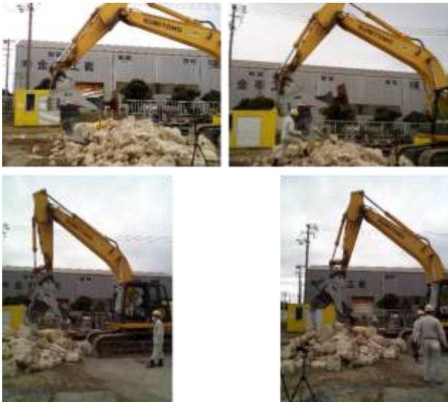
図-6.11 岩山に対する角度計測の様子 (左上図：掘り取り始め/右上図：掘り取り終わり/ 左下図：払い始め/右下図：払い終わり)
