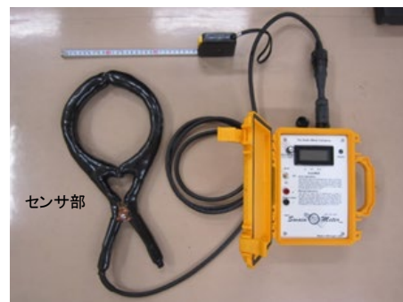
付図-B.1 水中で使用可能なクランプメータの一例 および測定状況イメージ
