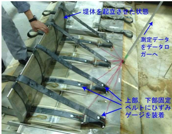
図-17 張力（波力）測定のためのひずみゲージを固定ベルトに取り付けた様子
