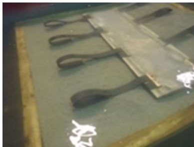
図-71 砂堆積状況写真（珪砂 3 号；平均粒径 1.7mm）
