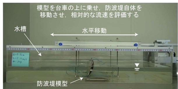
図-4 水流に対する応答特性評価実験装置
