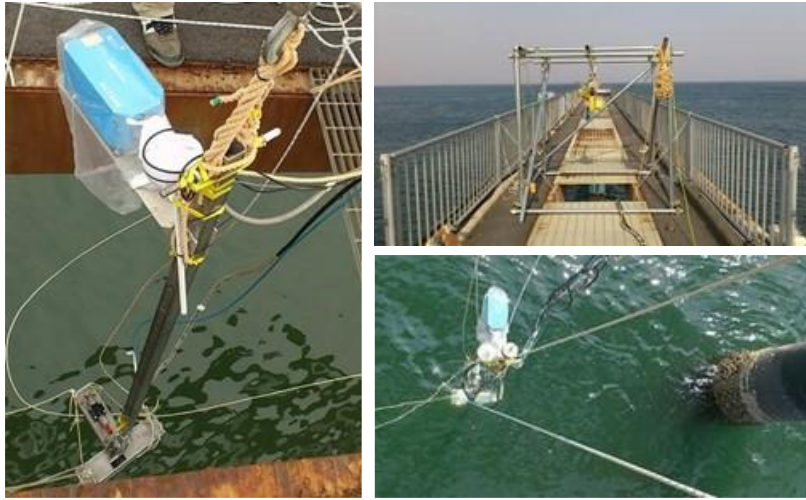
付図-53.7 2013年3月7日と8日に音響測深器でスキャナ計測
