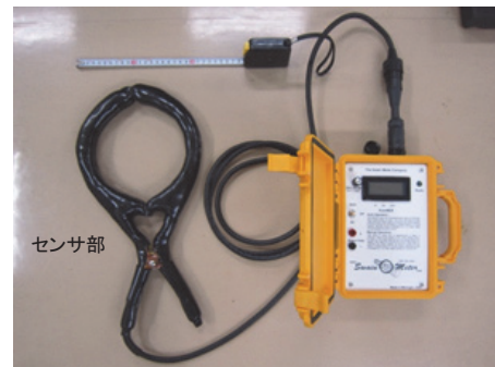
図-5.3 水中で使用可能なクランプメータの一例および測定状況イメージ
