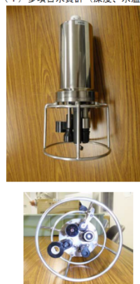
(1) 多項目水質計（深度、水温、電気伝導度、塩分、溶存酸素、濁度、クロロフィル計）
