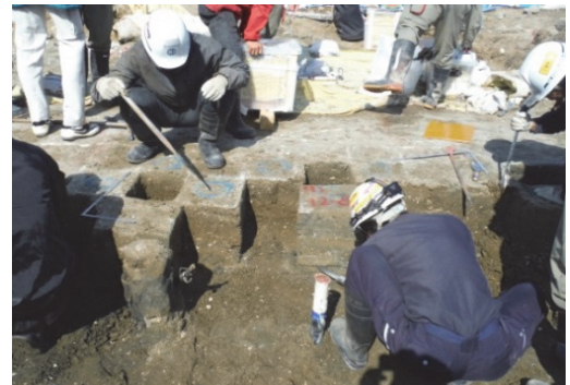
写真-3.3 ブロックサンプリング状況
