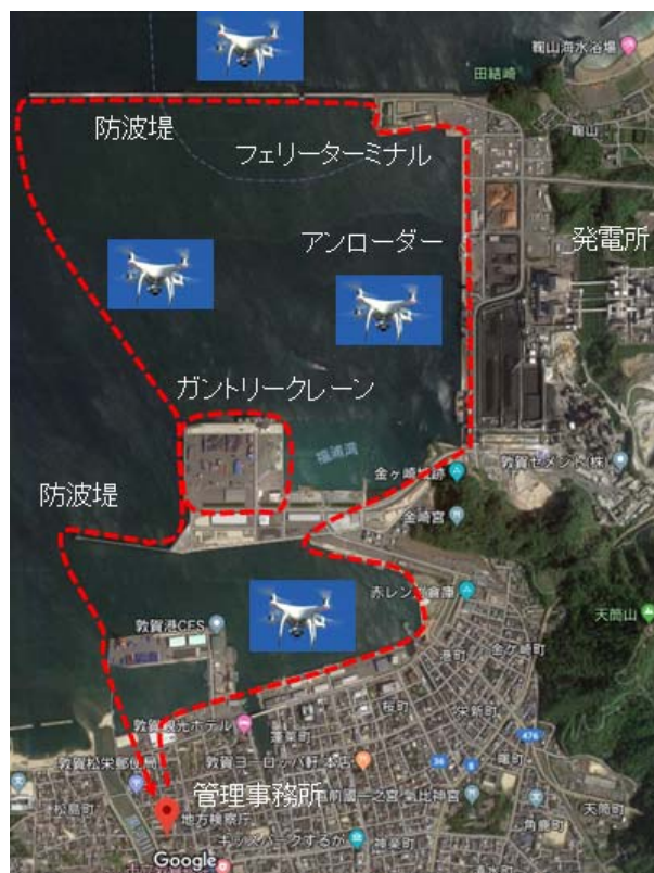
図-2.1 UAV を利用した災害時の初期調査イメージ
