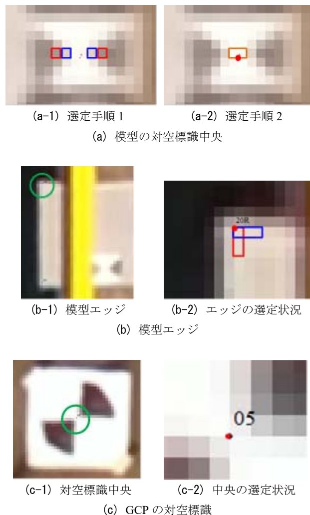
図-3.9 対空標識および模型エッジの変位評価位置の判定手順
