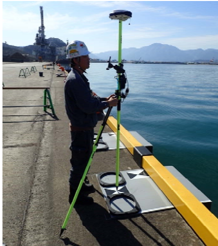
(a) 観測局 (スマートフォンで計測操作, 衛星受信機と無線受信機)
