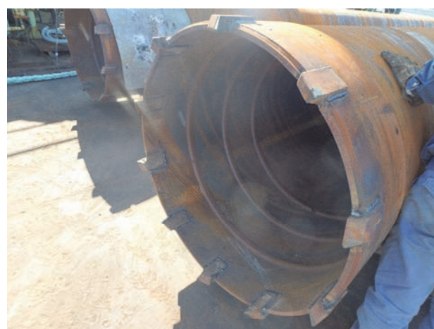
写真-1 杭の先端形状の例
