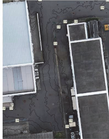
图-3.1.5 地点④：2017年台风 21 号推定浸水高 2.6m
