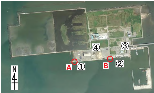
図-4.1 熊本港における調査位置（国土地理院のデータをもとに作成）。①は岸壁（-7.5m）、②はフェリーターミナル、③は液状化による段差が見られた箇所、④は液状化による噴砂の跡が見られた箇所。A、B は地震による残留水平変位の測量結果が得られている箇所（本文参照）。
