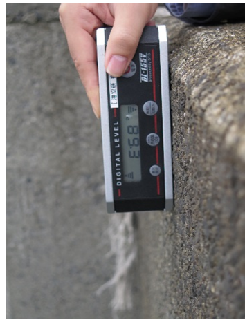
写真-5.7 石垣地区第二埠頭岸壁 (-5.5m) 南側の目地の開きと傾斜計による測定状況 (2016年4月18日撮影)
