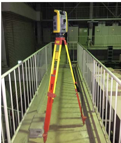
写真-3.2 トータルステーション（ニコン・トリンプル製 Trimble S6）
