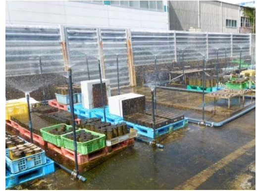
写真-3.2 海水シャワー場（飛沫帯を模擬）の外観
