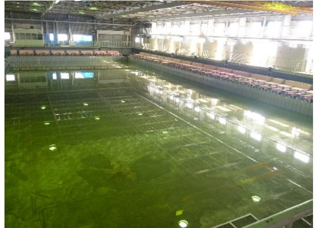
写真-2.1 改良後のデュアルフェースサーペント造波装置（写真右奥：水槽脇には制御基板・アンプユニットが並ぶ）
