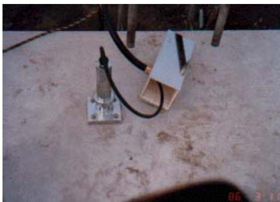
図-8 ERS-F, G, GV 型強震計の構造物取り付け用換振器
