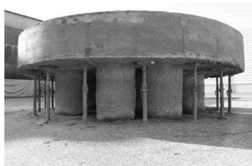
図-6.25 改良体（表層改良，改良杭）杭取出し後状況
