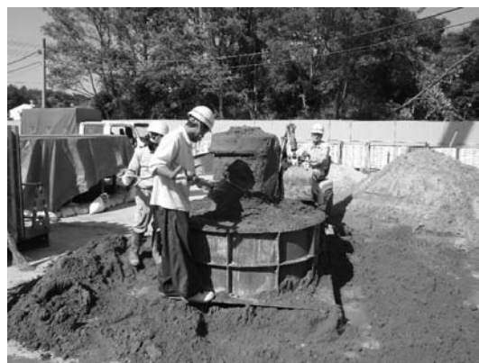
図-6.36 水平載荷試験体作製（試験体取出し）
