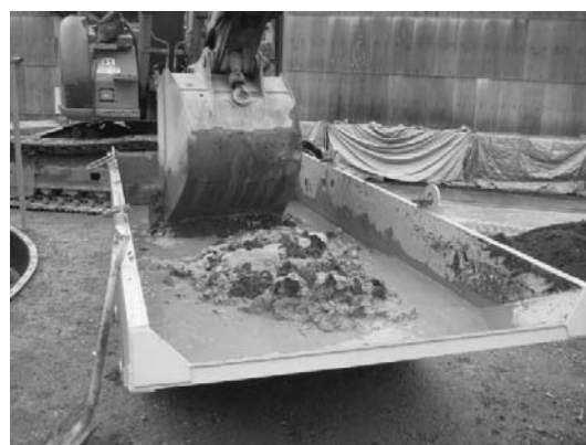
図-6.16 模擬地盤材料，固化材スラリーおよび顔料の練混ぜ状況
