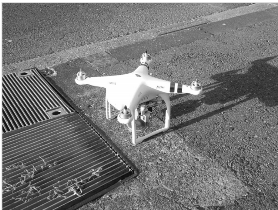
写真-3.1 マルチコプターに搭載されている GPS の緯度経度測定精度の検証状況
