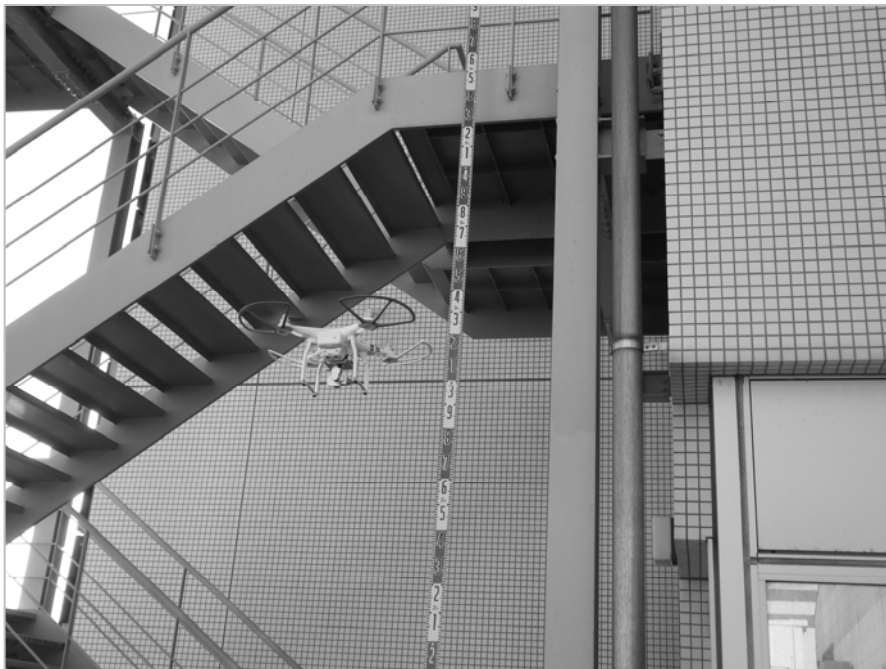
写真-3.2 マルチコプターに搭載されている GPS の高度測定精度の検証状況
