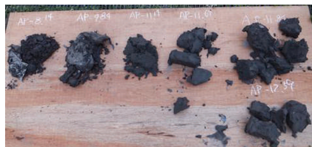
付録写真-2.8 深度毎の掘削土砂。A.P. -8.14m (左上) からA.P. -12.59m (右下) までの推移
