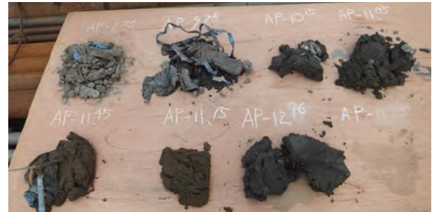
付録写真-2.6 深度毎の掘削土砂。A.P. -7.75m (左上) からA.P. -12.76m (右下) までの推移
