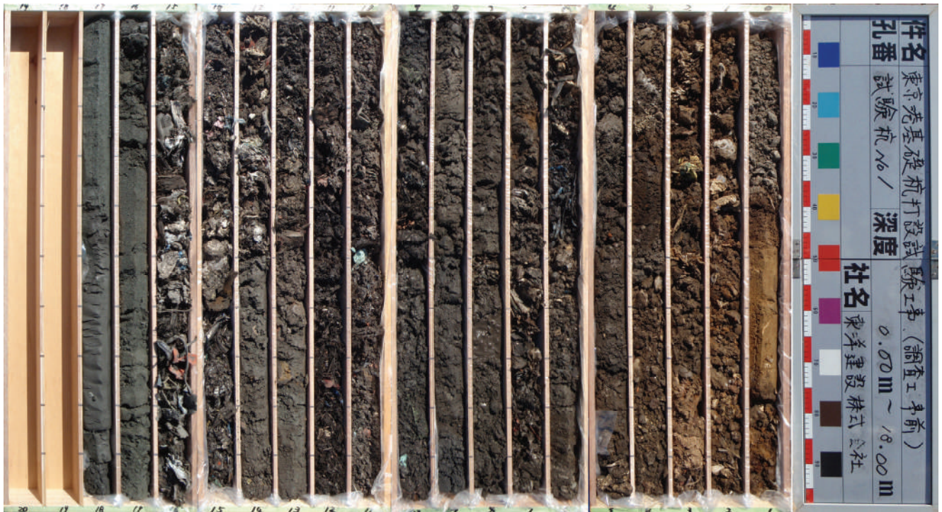
付録写真-1.1 ボーリングコア写真 (試験杭1近傍)
