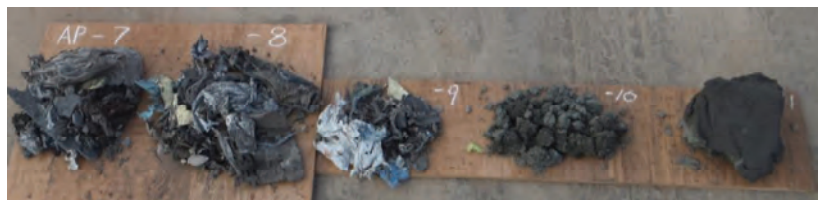
付録写真-2.1 試験杭1からの掘削土. A.P. -7m (左端) からA.P. -11m (右端) までの推移
